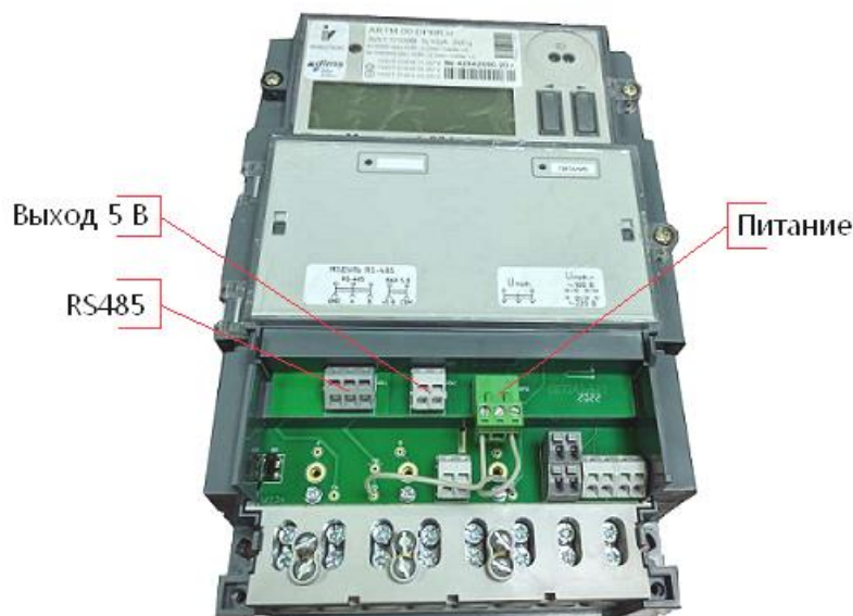
Рисунок 4.4 – Вид счетчика с модулем RS485 с элементами подключения
